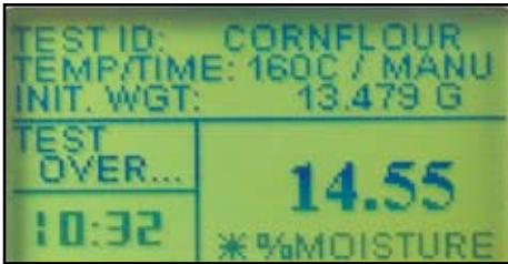
液晶显示屏，显示丰富测定信息
